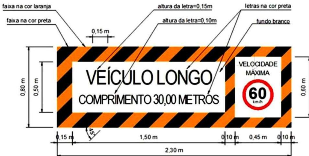
Figura 2: Sinalização especial de advertência traseira para comprimento excedente e limite de velocidade
