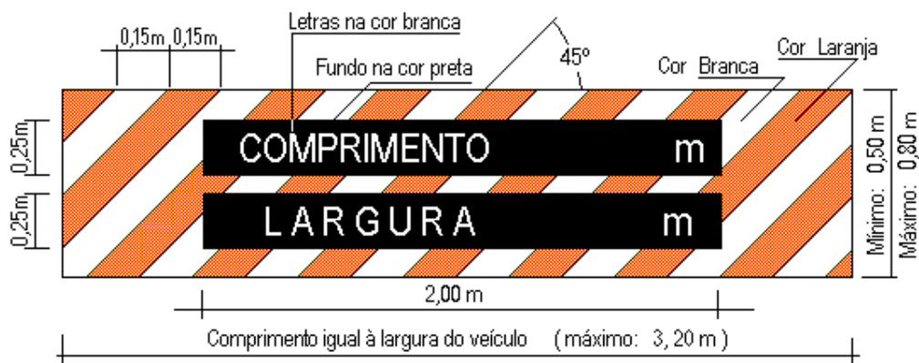
Obs.: Placa metálica com película refletiva, com faixas inclinadas de 45°, da direita para a esquerda e de cima para baixo, nas cores branca e laranja.
