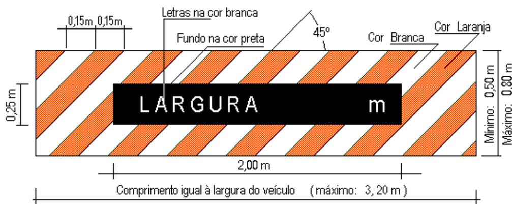
Obs.: Placa metálica com película refletiva, com faixas inclinadas de 45°, da direita para a esquerda e de cima para baixo, nas cores branca e laranja.
